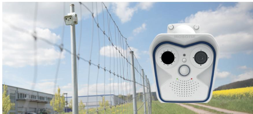
uniquement lors d'événements importants critiques pour la sécurité. MxActivitySensor 2.0 différencie en effet la taille des objets en fonction de la perspective, permettant ainsi de réduire le nombre de fausses alertes déclenchées d'une part par la pluie, la neige, des arbres ou des mâts de caméra en mouvement, et d'autre part par des oiseaux ou
